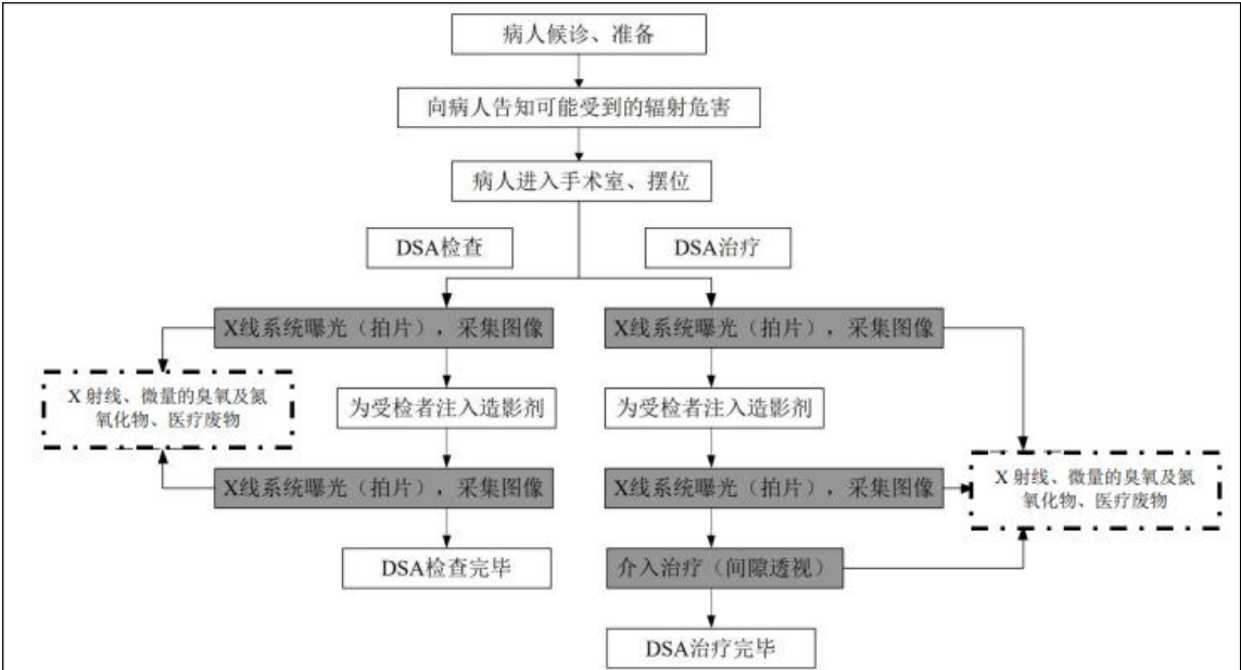
图 2-8 DSA 介入治疗流程及产污环节示意
